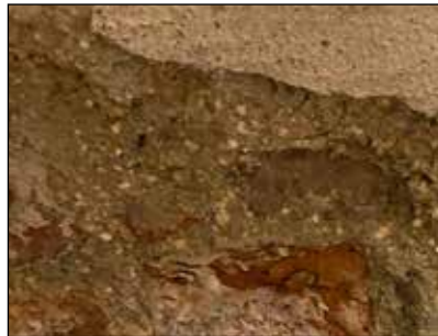
Kalkrika mur- och putsbruk utan krympsprickor med inslag av rostade mjuka kalkklumpar. Den vänstra är senmedeltida innehållande lera och det högra från 1700-talet. Båda med lika vikt delar kalk och den ballast som fanns tillhands.
