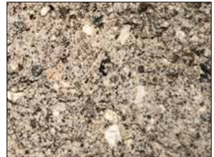
Kalkrika mur- och putsbruk utan krympsprickor med inslag av rostade mjuka kalkklumpar. Den vänstra är senmedeltida innehållande lera och det högra från 1700-talet. Båda med lika vikt delar kalk och den ballast som fanns tillhands.
